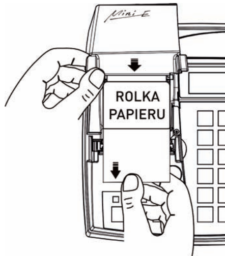
Rys. 2-4 Wkładanie rolki papieru
