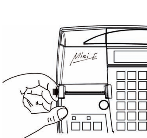
Rys. 2-3 Podnoszenie pokrywy drukarki
