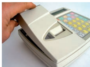
Rys. 2-11. Zamykanie osłony drukarki
