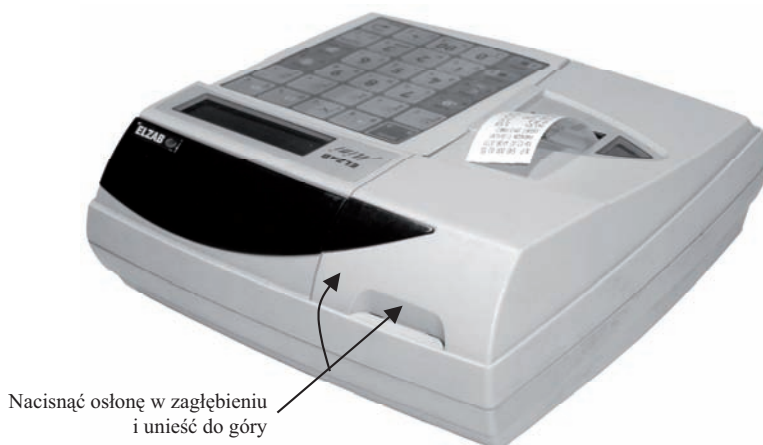
Rys. 1-2. Otwieranie osłony drukarki
